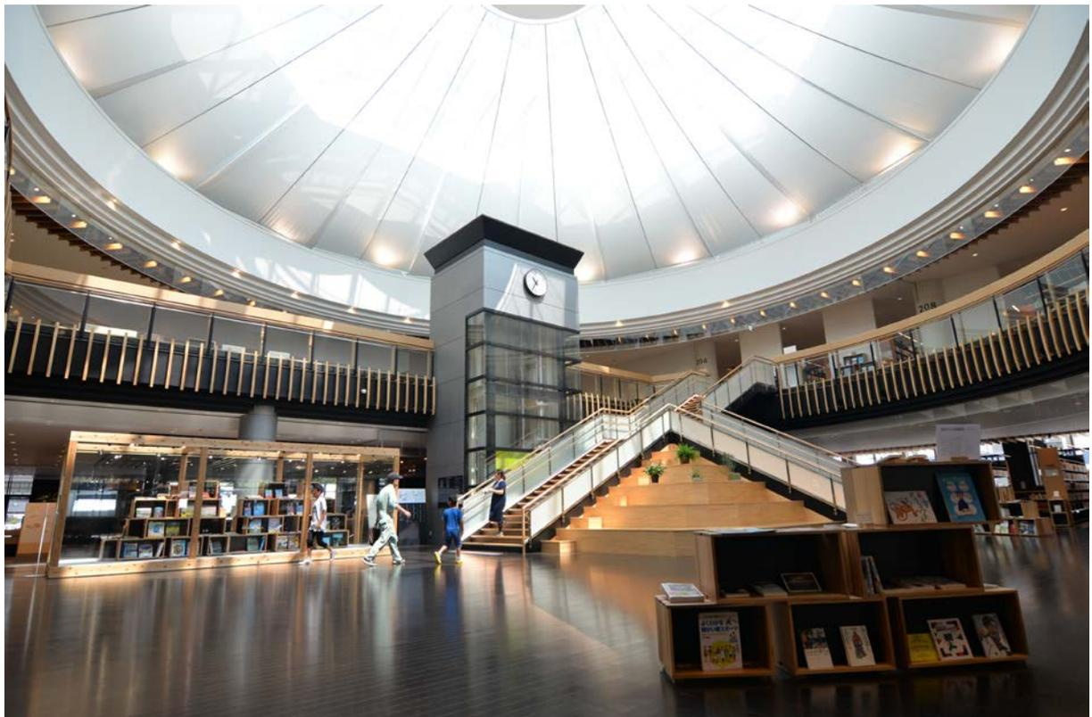
ホールを1階から見る。時計塔は既存のまま残し、エスカレーターを二股の大階段に変更した(写真: 菅原 由依子)
