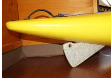
安定板を加えた船底。初心者でもひっくり返りにくくなっている。
